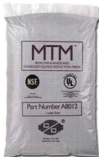
Clack MTM® (sacco da 14,15 l) Descrizione Clack MTM® è un mezzo filtrante granulare a biossido di manganese utilizzato per ridurre ferro, manganese e acido solfidrico dall'acqua potabile. Il suo rivestimento superficiale attivo ossida e precipita ferro e manganese solubili. L'idrogeno solforato viene ossidato a zolfo. I precipitati vengono filtrati nel letto granulare e rimossi mediante controlavaggio. PROPRIETÀ FISICHE
