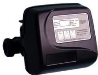
Portata servizio perdita di carico @ 1 bar/15 psi : 102 lpm (incluso contatore e bypass - Portata controlavaggio perdita di carico @ 1.7 bar/25 psi : 102 lpm (incluso bypass) Bombe applicabili: Addolcitore diam. 6" - 21" /Filtro diam 6"- 21"- Racc.Entrata/Uscita 3/4" - 1.25" Maschio BSPT 3/4" - 1.5" Saldare 3/4" - 1.5" incollaggio - Materiale: Noryl - Cicli: fino a 9 Rigenerazione:
