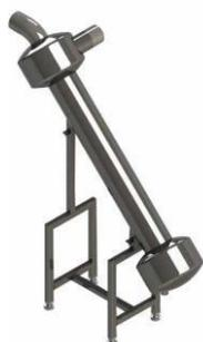
Il filtro idrociclone, o filtro tangenziale, o separatore centrifugo di sabbia, è spesso considerato un prefiltro per la pulizia di liquidi o acque molto sabbiose o sature di particelle solide come ghiaia, o in genere da particelle più pesanti dell'acqua. Viene solitamente montato prima di una stazione di filtrazione vera e propria. Senza particolare manutenzione, filtra acque provenienti da:
