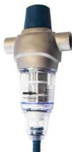
Filtro pulente doppia azione. Ruotando la manopola in senso orario si aziona il controlavaggio con risciacquo della cartuccia e scarico delle impurità residue
