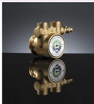
Caratteristiche tecniche e di fabbricazione Le pompe rotative sono realizzate in ottone con un rotore in AISI 303 mentre la camera pompante e le palette sono in grafite. Le porte di aspirazione e di mandata sono da 3/8" NPT/GAS. Le pompe sono predisposte per essere montate direttamente sul motore con una fascetta in acciaio inossidabile. Per le diverse alternative di montaggio si vedano le informazioni tecniche "optional mountings". Temperatura di esercizio massima: 70 °C.
