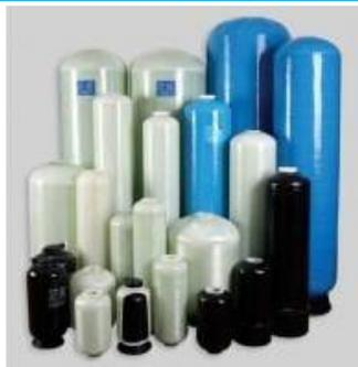
PVA - FRP Bombe con base Materiale: PE alimentare - Rinforzato fibra di vetro Colore Standard: Blu Certificazioni: NSF, D.M.174 - Ciclo di prova minimo: 250.000 cicli da 0 a 10 bar - Pressione massima d'esercizio: 10 Bar - Temperatura massima d'esercizio 45°C Sottovuoto max 140 mm Hg
