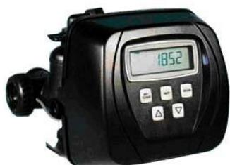
Portata servizio perdita di carico @ 1 bar/15 psi : 102 lpm (incluso contatore e bypass - Portata controlavaggio perdita di carico @ 1.7 bar/25 psi : 102 lpm (incluso bypass) Bombole applicabili: Addolcitore diam. 6" - 21" /Filtro diam 6"- 21" - Racc.Entrata/Uscita 34" - 1.25" Maschio BSPT 34" - 1.5" Saldare 34" - 1.5" incollaggio - Materiale: Noryl - Cicli: fino a 9 Rigenerazione:
