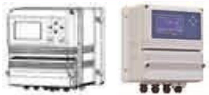
Comando per pilotare impianti di osmosi inversa. Fornito senza sonda di conducibilità. Costruito a microprocessore. Display LCD. Alloggiamento IP65 o disponibile in formato rack 180x220x80 mm. Lettura conducibilità d'ingresso e d'uscita Controllo livelli vasca di accumulo Pressione minima e massima Controllo lavaggio delle membrane Controllo termica pompa di pressione Controllo remoto da addolcitore. Disponibile sia in versione da quadro che in versione in scatola IP 65
