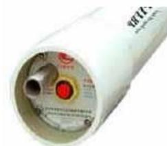
Master-Line contenitore a pressione per membrane V-3 serie è disponibile sia con configurazione End Port, sia Side Port pressione nominale da 150 a 1200 psi e lunghezza da 1 a 7 elementi.
