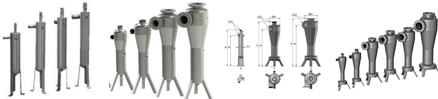
Il filtro idrociclone, o filtro tangenziale, o separatore centrifugo di sabbia, è spesso considerato un prefiltro per la pulizia di liquidi o acque molto sabbiose o sature di particelle solide come ghiaia, o in genere da particelle più pesanti dell'acqua. Viene solitamente montato prima di una stazione di filtrazione vera e propria. Senza particolare manutenzione, filtra acque provenienti da:
