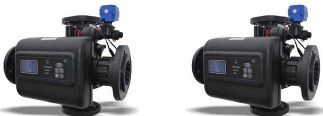
VS40SM Valvola per addolcitore controcorrente Display: LCD Tipo di installazione: montaggio laterale (Side Mount) Tipo di controllo : Volumetrica/Cronometrica a scelta Connessione ingresso/uscita: DN65 o DN80 (2,5" / 3") Dimensioni scarico : G 2"
